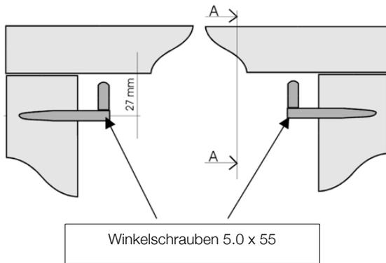
Platzieren Sie **2.7cm unter der Oberkante** des Türrahmens links und rechts je eine mitgelieferte Winkelschraube (5.0 x 55).
