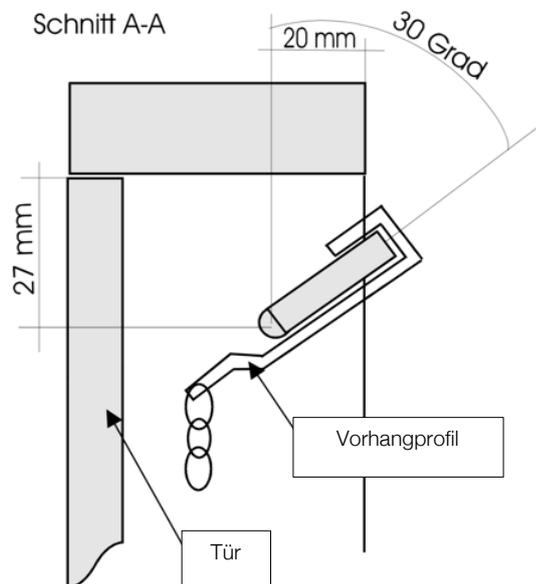
Drehen Sie die beiden Winkelschrauben links und rechts, sodass die Schenkel ca. **30 Grad nach aussen geneigt** sind.
