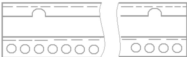
Profil frontal am Türrahmen oder auf der Fassade montiert, eingehängt in zwei Rundkopfschrauben.
