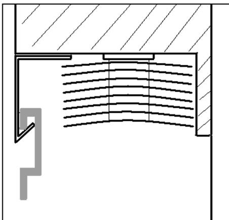
Profil eingehängt in bestehende Metallblende des Storenkastens
